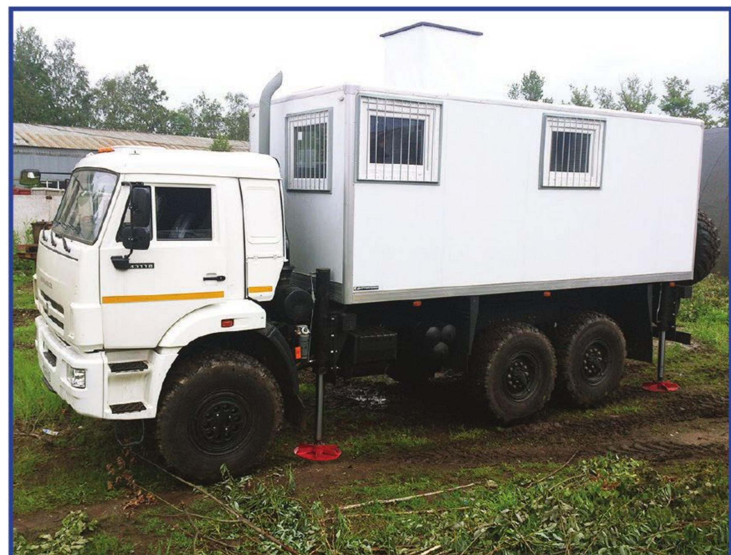
Завод Буровых Технологий производит выпуск серии установок статического зондирования УСЗ-15.ЗВТ, УСЗ-20.ЗВТ и УСЗ-25.ЗВТ на базе шасси КАМАЗ 43118 и 63501.
