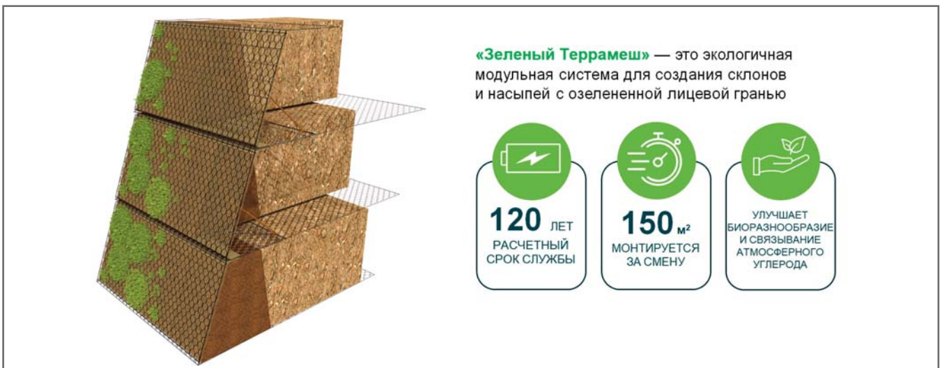
Рис. 3. Схематическое изображение устройства армированного сооружения на основе системы «Зеленый Террамеш» и преимущества этой системы
