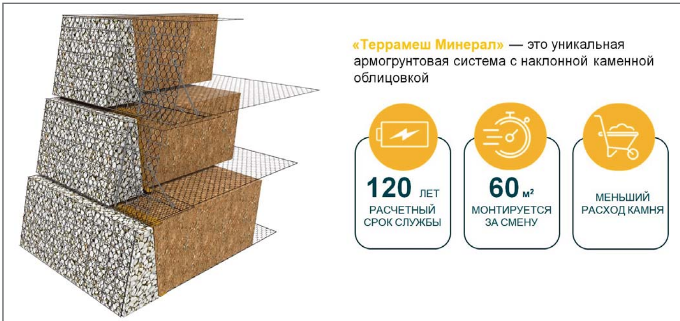
Рис. 5. Схематическое изображение устройства армогрунтового сооружения на основе системы «Террамеш Минерал» и преимущества этой системы
