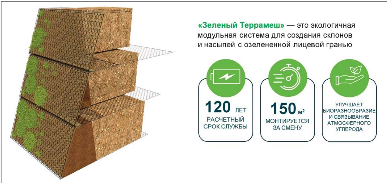
Рис. 3. Схематичное изображение устройства армогрунтового сооружения на основе системы «Зеленый Террамеш» и преимущества этой системы
