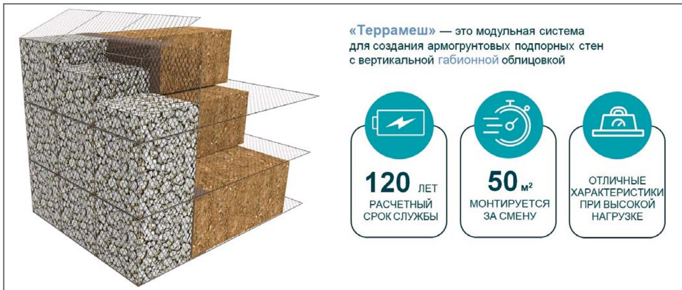
Рис. 1. Схематичное изображение устройства армированного сооружения на основе системы «Террамеш» и преимущества этой системы
