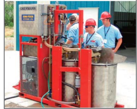
Рис. 13. Использование насосных станций для нагнетания цементного раствора от простых ручных вариантов до полуавтоматических или полностью автоматических [8]
