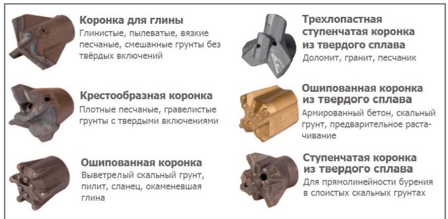
Рис. 6. Основные типы буровых коронок [8]
