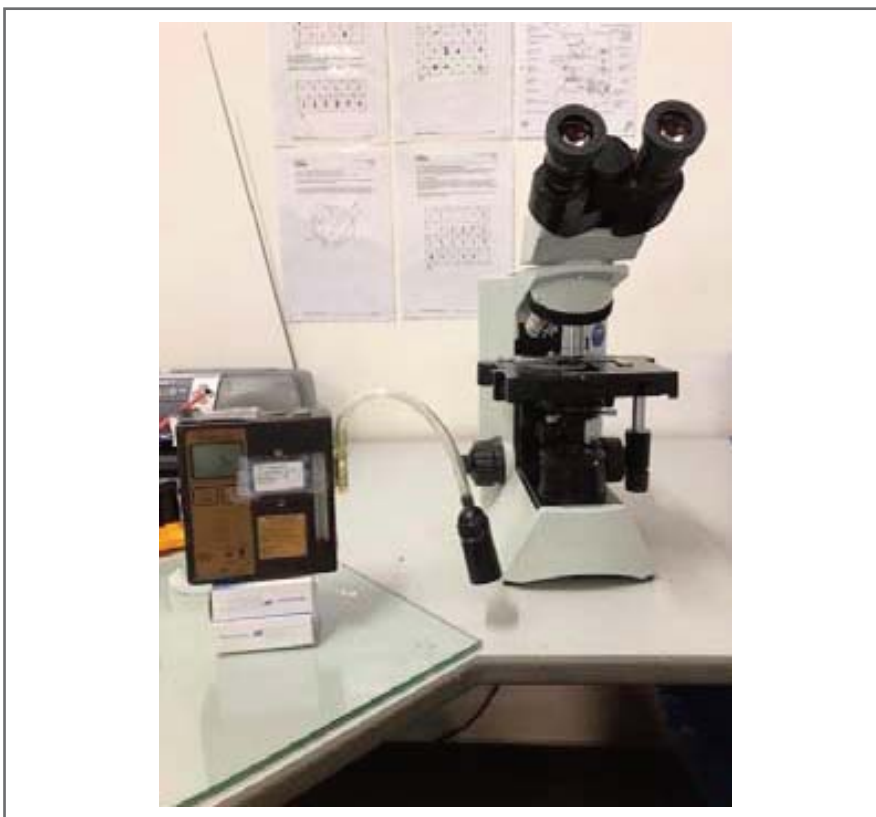
Рис. 9. Насос для микроскопического контроля количества и размера взвешенных частиц в воздухе и присоединенный к нему фильтр
