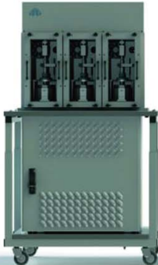
Прибор компрессионный криологический ГТ 1.1.11
