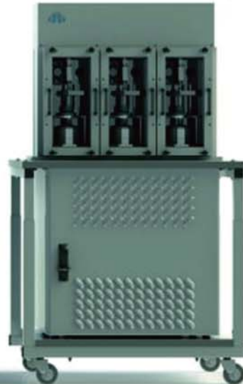
Прибор шариковый штамп криологический ГТ 1.6.2
