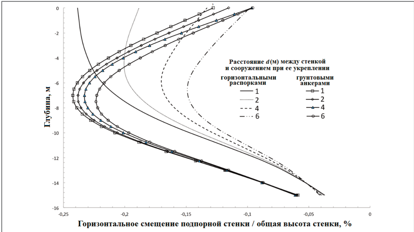
Рис. 8. Изменения горизонтальных смещений подпорной стенки с глубиной при разных расстояниях ( d ) между ней и соседним наземным сооружением
