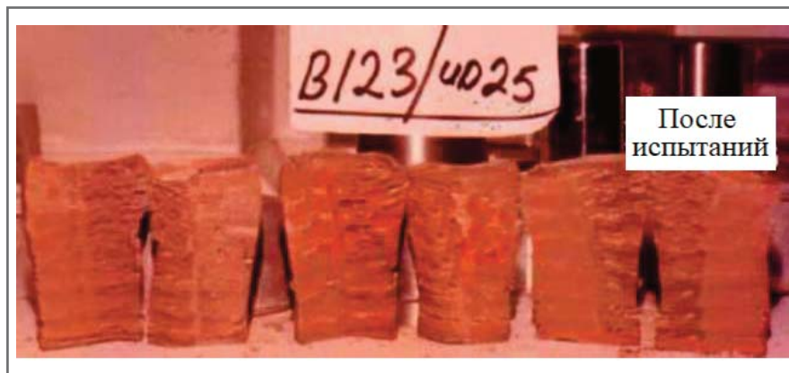
Рис. 4. Ненарушенные образцы, разрезанные после испытаний
