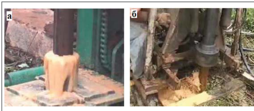
Рис. 7. Вода (буровой раствор) выносит шлам наверх (а); водоструйная технология, при которой скважина углубляется путем разрушения грунта при вращении бурильной трубы и подаче напорной струи воды с колебаниями подачи и напора (б)
