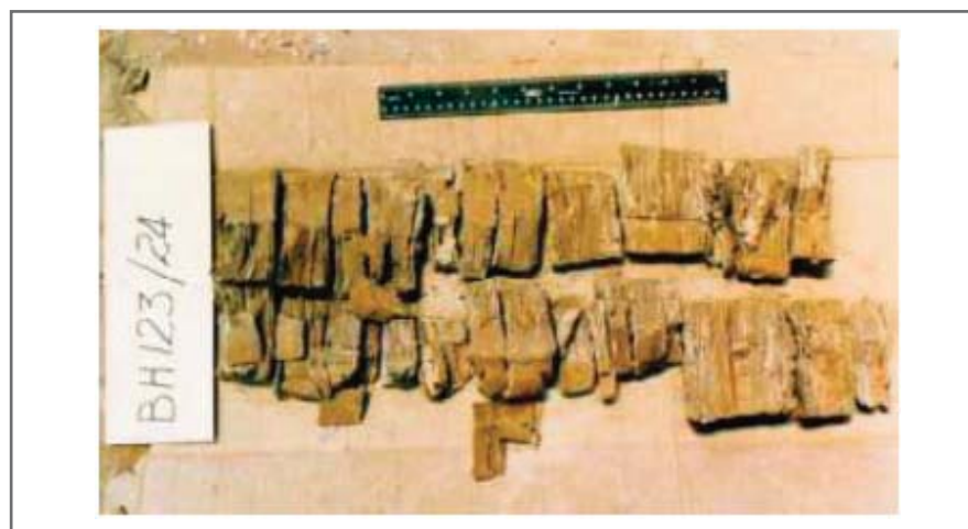
Рис. 6. Образцы, взятые из скважины ненарушенными, после извлечения и высыхания продемонстрировали все неоднородности слоев грунта
