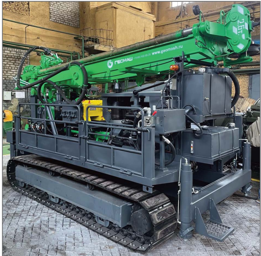
Рис. 1. ПБУ-2 и другое оборудование на самоходной гусеничной тележке
