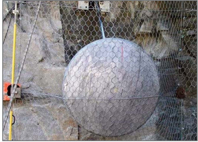
Рис. 5. Испытание конструкции «Стилгрид®» на продавливание
