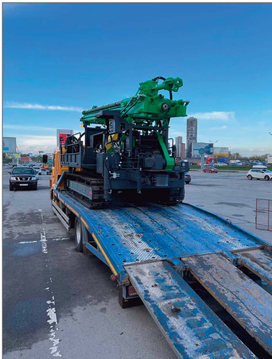
Рис. 2. Перевозка ПБУ-2 на гусеничной тележке на дальние расстояния с помощью быстроходной грузовой техники
