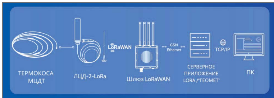
Рис. 8. Автоматизированный мониторинг температуры при помощи логгера ЛЦД-2-LoRa
