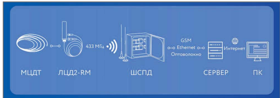
Рис. 11. Автоматизированный мониторинг температуры при помощи логгера ЛЦД2-РМ
