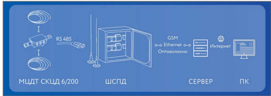
Рис. 10. Автоматизированный мониторинг температуры при помощи стационарного контроллера СКЦД
