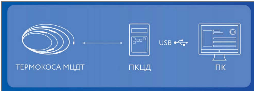
Рис. 3. Мониторинг температуры в ручном режиме при помощи переносного прибора ПКЦД
