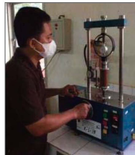
Рис. 6. Испытание образца грунта на одноосное сжатие
