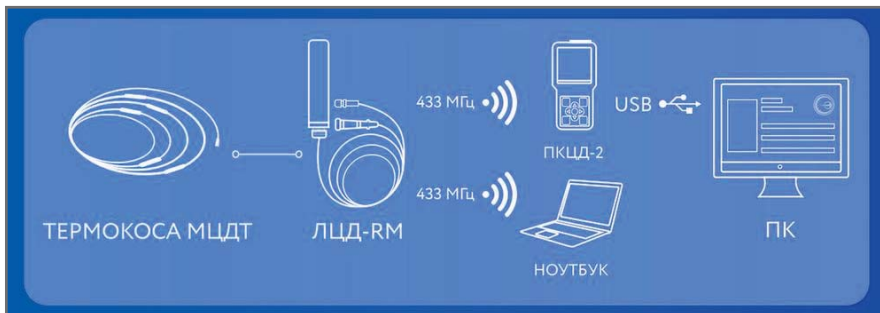
Рис. 5. Мониторинг температуры в ручном режиме при помощи логгера с радиоканалом ЛЦД-2-RM
