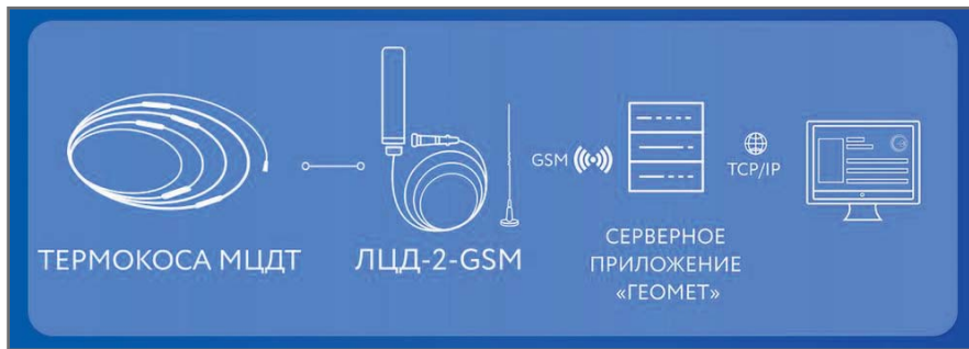
Рис. 7. Автоматизированный мониторинг температуры при помощи логгера ЛЦД-2-GSM
