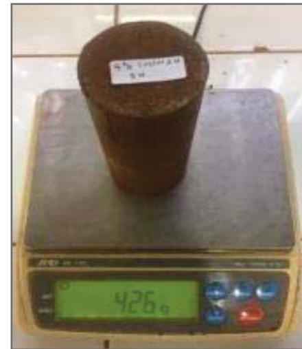
Рис. 5. Образец грунта перед испытанием на одноосное сжатие
