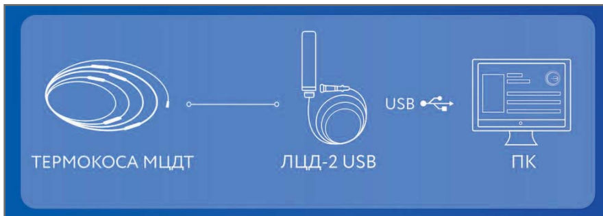
Рис. 4. Мониторинг температуры в ручном режиме при помощи логгера с USB-выходом
