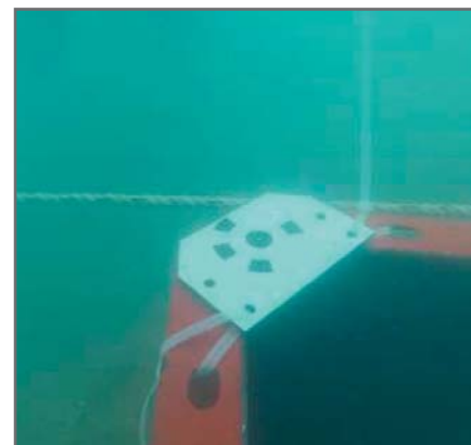
Рис. 10. Использование маркеров программы Agisoft Pgtoscan Pro для более хорошего автоматического совмещения снимков при обработке (фото Феликса Педротти)
