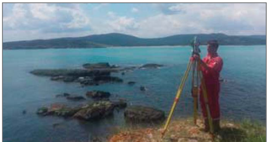
Рис. 8. Использование тахеометра Leica FlexLine TS06plus для географической привязки неподвижных точек раскопов (фото Майкла Гранта (Michael Grant))
