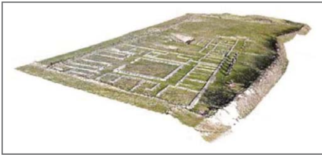
Рис. 5. Облако точек, полученное с помощью камеры видимого диапазона (RGB)
