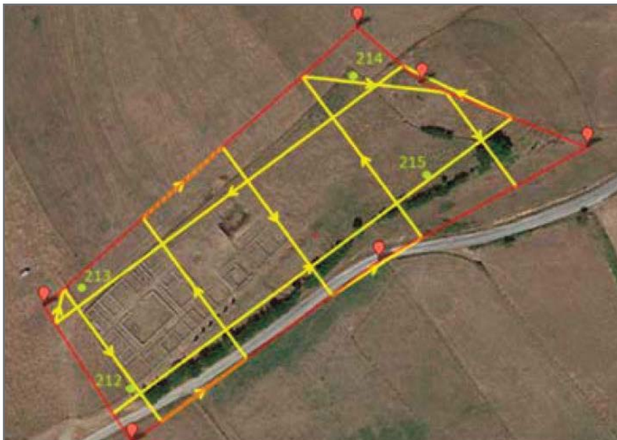
Рис. 3. Результаты планирования полета и выбора опорных точек
