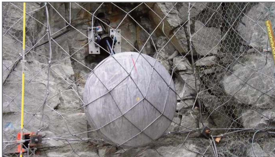
Рис. 2. Тест на продавливание
