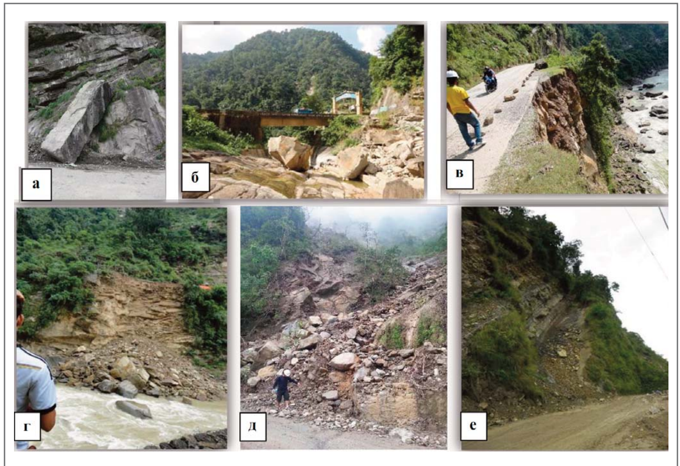
Рис. 10. Случаи обрушений скального склона в исследуемом районе в результате: разрушения на блоки (а, б); возникновения оползня небольшого масштаба с образованием на склоне «рубца» (поверхности отрыва) (в); комбинации возникновения оползня небольшого масштаба и потока обломочного материала / небольшого селя (г–е) (по [3])
