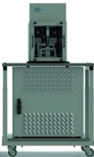
Прибор срезной криологический ГТ 1.2.14
