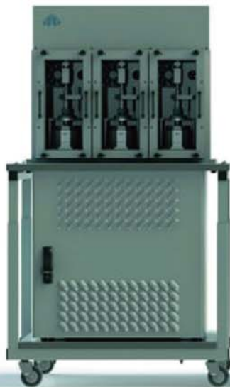
Прибор компрессионный криологический ГТ 1.1.11
