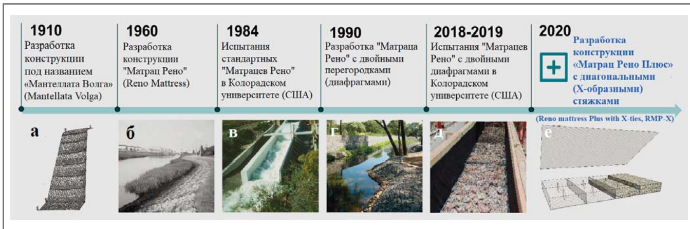
Рис. 1. Этапы развития конструкций для строительства берегоукрепительных систем в компании «Маккаферри» с 1910 по 2020 год
