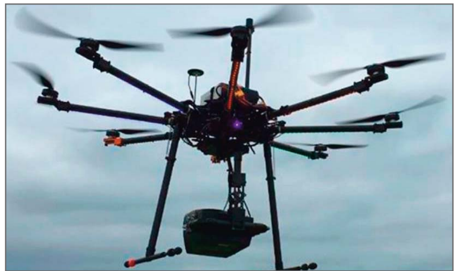
Рис. 2. Лидар Yellowscan Mapper, прикрепленный снизу к летящему октокоптеру
