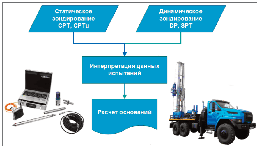
Рис. 12. Структурная схема полевых испытаний и проектирования оснований при использовании технологии информационного моделирования Geotek BIM
