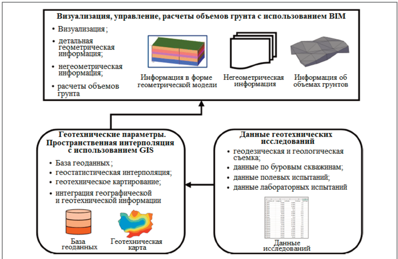
Рис. 8. Схема интеграции GIS и BIM (по Khan et al., 2021)
